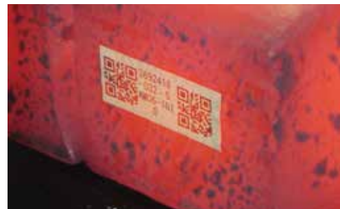
1000℃の高熱に耐えるバーコードラベル 写真提供:合同製鐵株式会社
